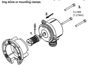
Montage über flanschseitige Gewindebohrungen/Mounting via threaded holes on the flange side
