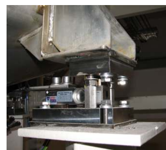
Одно - или несколько сосудов для взвешивания материалов, используемых в технологическом процессе
