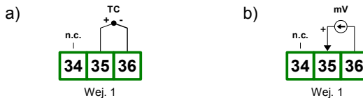
Rys. 4.15. Podłączenia zewnętrzne dla kanału nr 1: a) czujników termoparowych; b) czujników napięciowych
