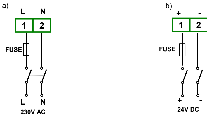
Rys. 4.6. Podłączenie zasilania a) dla wersji 230V AC; b) dla wersji 24V DC
