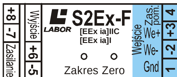
Rys.3. Opis zacisków podłączeniowych.
